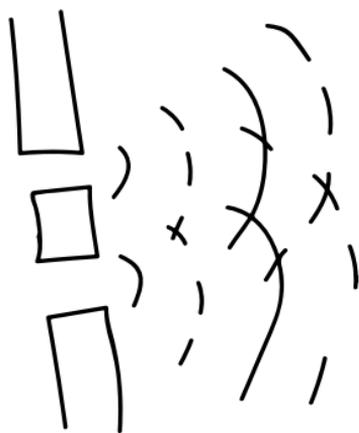
Par endroits, les vagues se superposent parfaitement, la crête de la première correspond exactement à la crête de la seconde, si bien qu'on observe une méga-crête à la surface de l'eau. Entre ces méga-crêtes, on constate l'effet inverse, où la crête de l'une rencontre le creux de l'autre. En ces endroits, les vagues se neutralisent, et la surface de l'eau est presque lisse.
